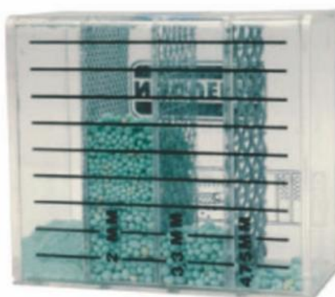
Figure 6.4 - Exemple de granulomètre pour engrais
