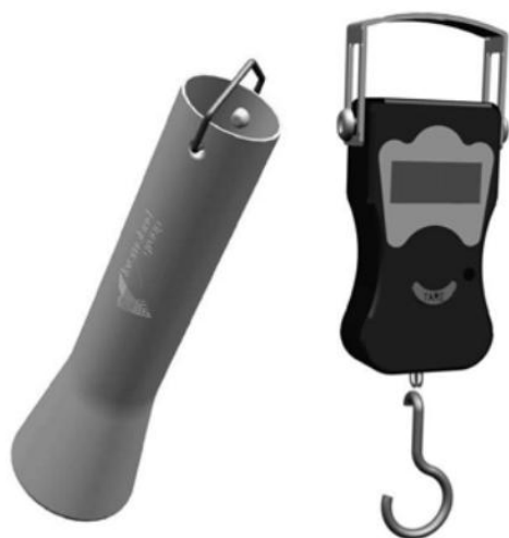
Figure 6.8 - Équipement ex. pour la détermination du poids spécifique
